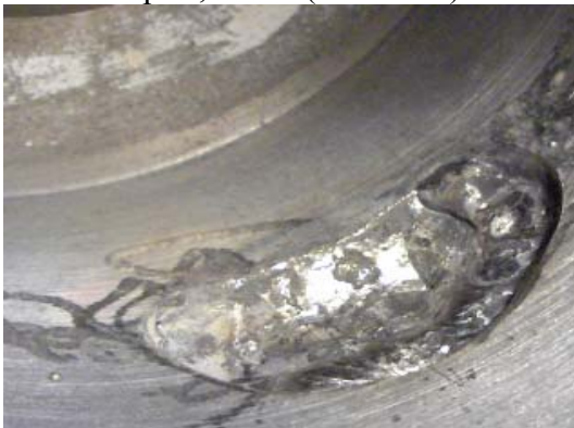
obr. 9 navaření první vrstvy elektrodou GOLD 2 pr.3,2 mm (Ni 98 %)
