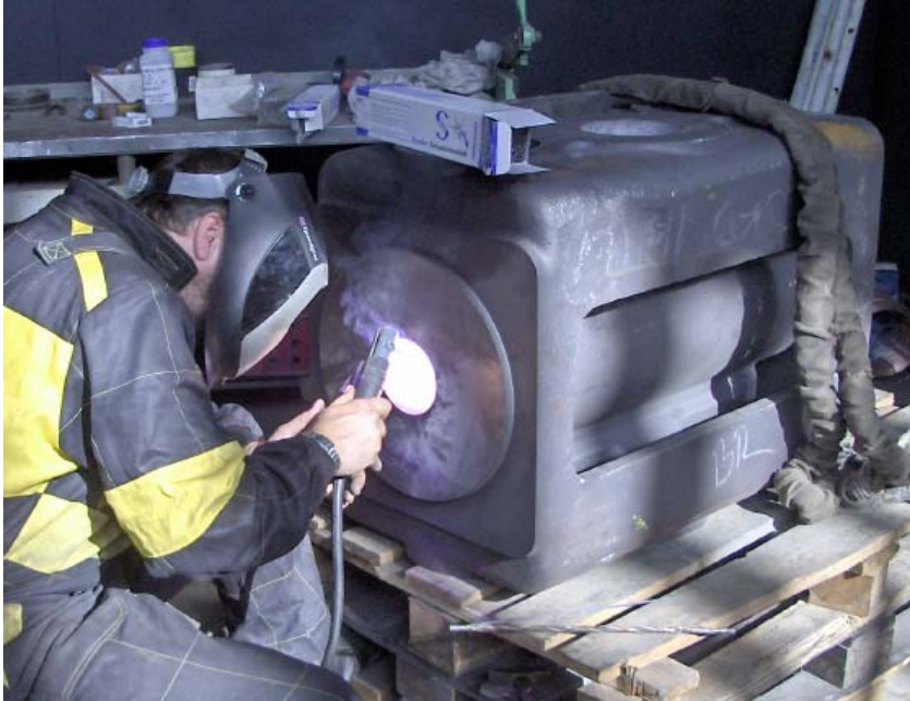
obr. 9 navaření první vrstvy elektrodou GOLD 2 pr.3,2 mm (Ni 98 %)
