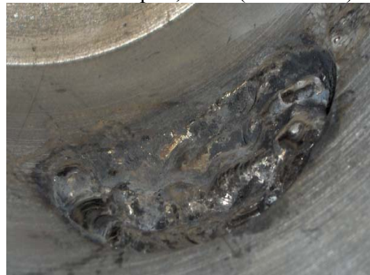
obr. 10 navaření mezivrstvy elektrodou SUPER NIFE pr.3,2 mm (NiFe 60/40)
