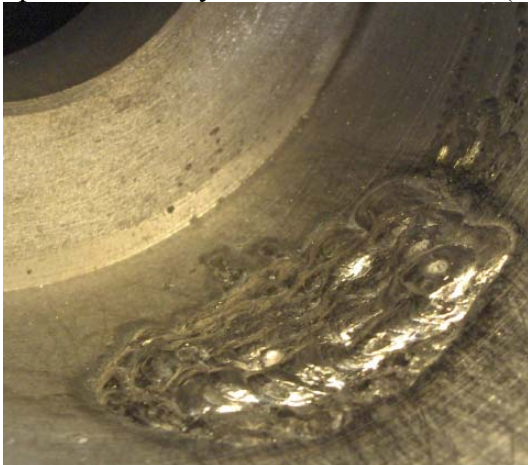
Obr. 11 krycí vrstva navařená elektrodou GOLD 2 pr. 3,2 mm, pro lepší obrobiteľnosť opravené vady v tělese odlitku ( otvor s tolerancí pro uložení ucpávky)
